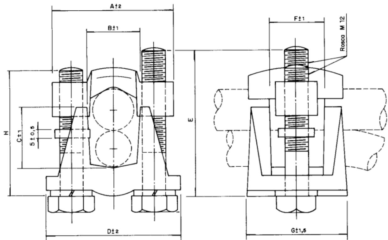
Figura 1 – Conector Tipo Grampo de Encaixe
